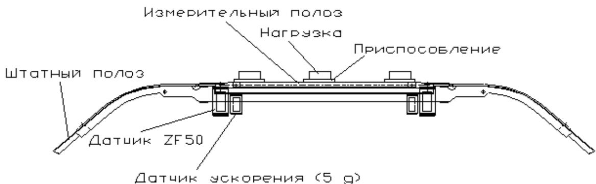
Рис. 4. Размещение приспособления и нагрузки на ползунке измерительном.
