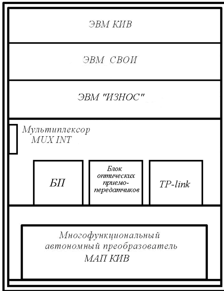
Рисунок 2 – Размещение оборудования в стойке КИВ
