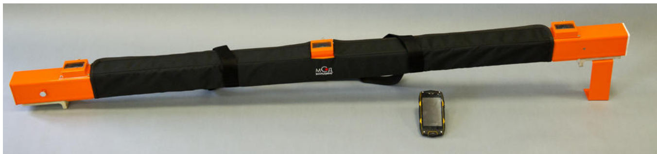
Рисунок 1. Устройство портативное для измерения параметров контактной сети «ТЕЛЕКС-2»
