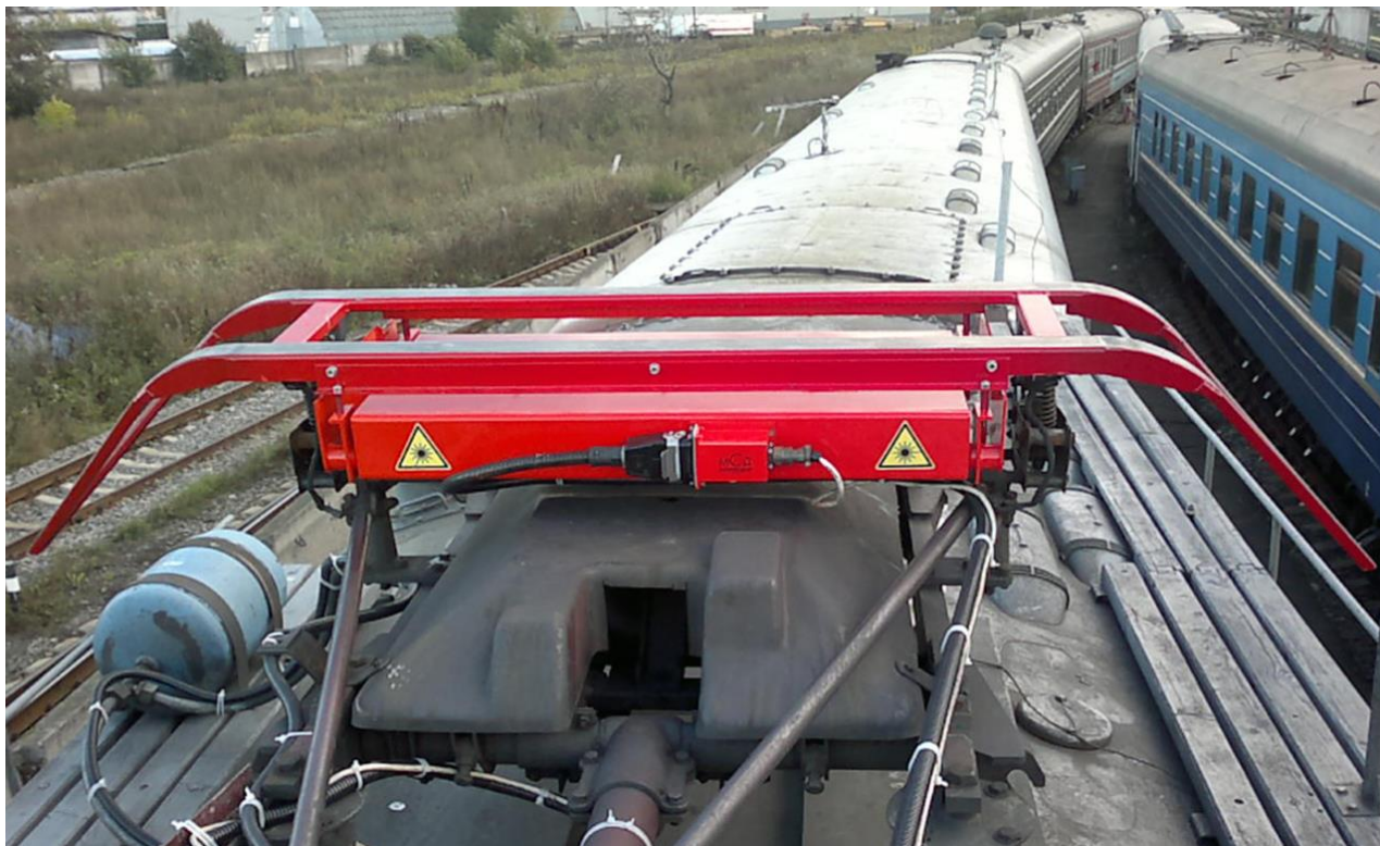
Рисунок 7. Внешний вид Полоза измерительного, установленного на токоприемнике.
